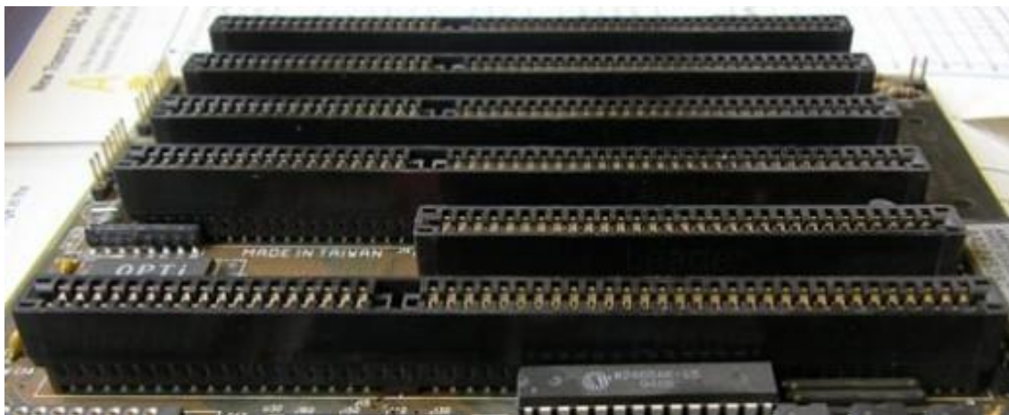
Рисунок 1 - 5 разъемов 16-битной и 1 разъем 8-битной шины ISA [3]
